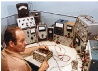
Bij de PTT Centrale Werkplaats werden semafoons in een kooi van Faraday gerepareerd wegens
