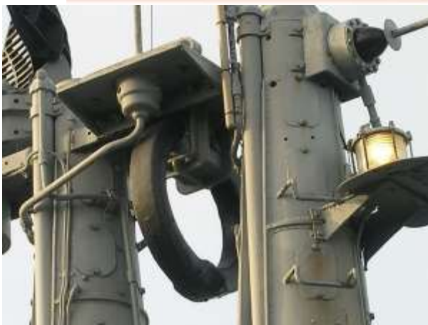
VLF antenne in de mast van een onderzeeër
